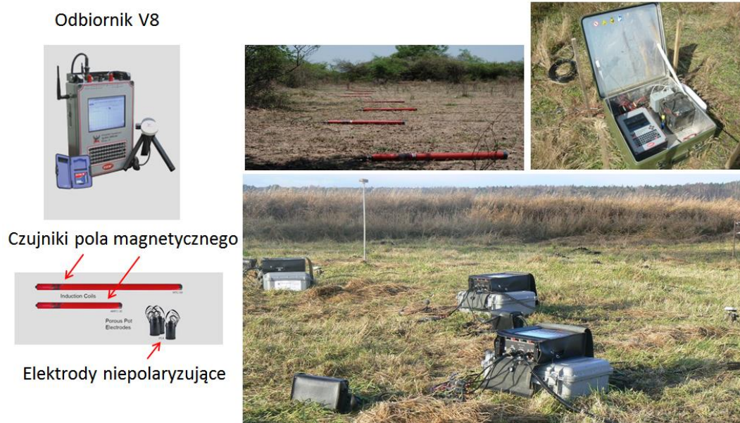
Fig. 3.5.3. Aparatura pomiarowa i czujniki pola magnetycznego
