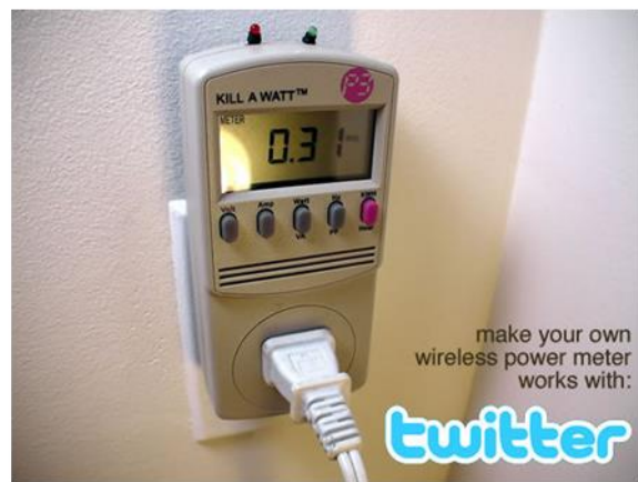
Rys. 3.6. Miernik energii wysyłający informacje na Twitter Mikrokontroler Arduino wykorzystuje połączenia WiFi do przesyłania wyników pomiarów.
