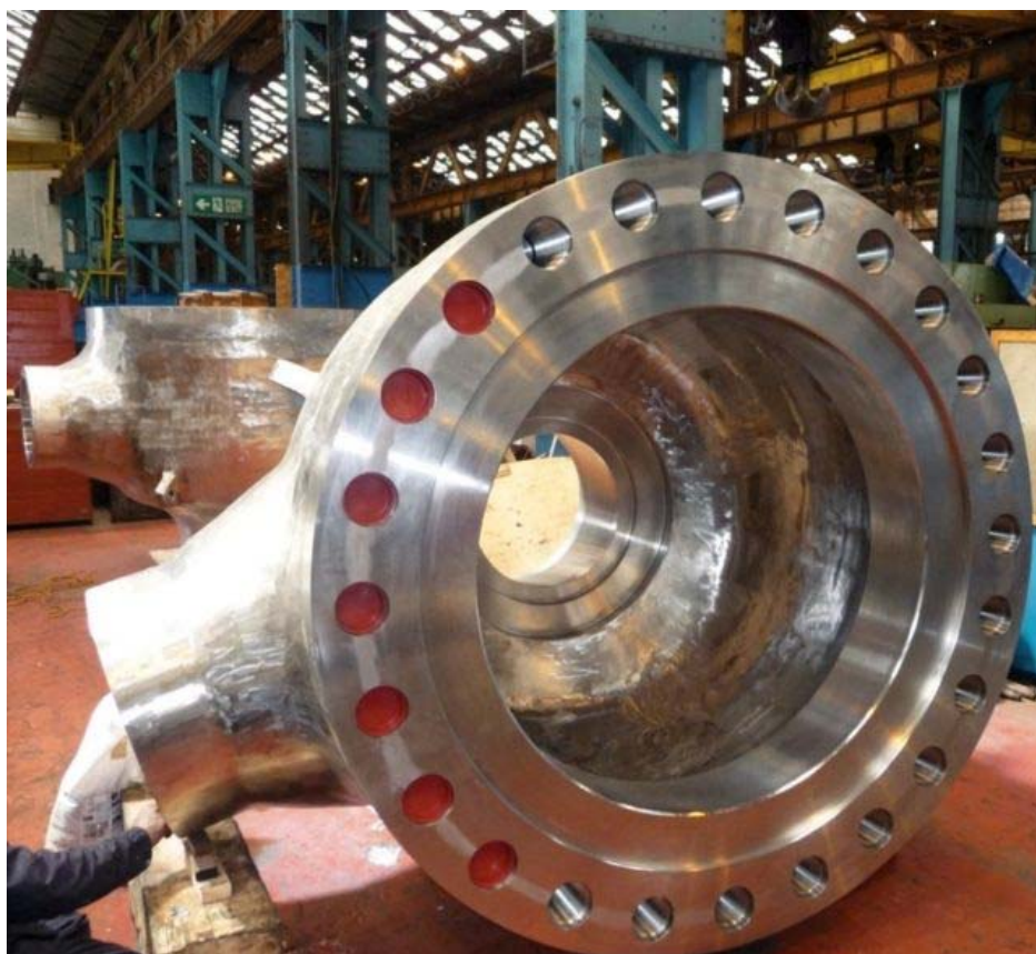
Rys. 11. Odlew fragmentu korpusu pompy reaktora AP1000 o wadze 16 ton [26]
