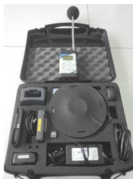
Ilustracja. 3. Miernik poziomu dźwięku SVAN 948 oraz zestaw do pomiaru drgań mechanicznych Vib008 – Pracownia fizyczna laboratorium Wojewódzkiej Stacji Sanitarно-Epidemiologicznej w Kielcach
