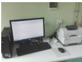
Ilustracja. 4. Spektrometr FT-IR Nicolet iS5 z wyposażeniem do oznaczania krystalicznej krzemionki – frakcja respirabilna pyłów (kwarc, krystobalit) – Pracownia pyłów i mikroklimatu laboratorium Wojewódzkiej Stacji Sanitarно-Epidemiologicznej w Kielcach
