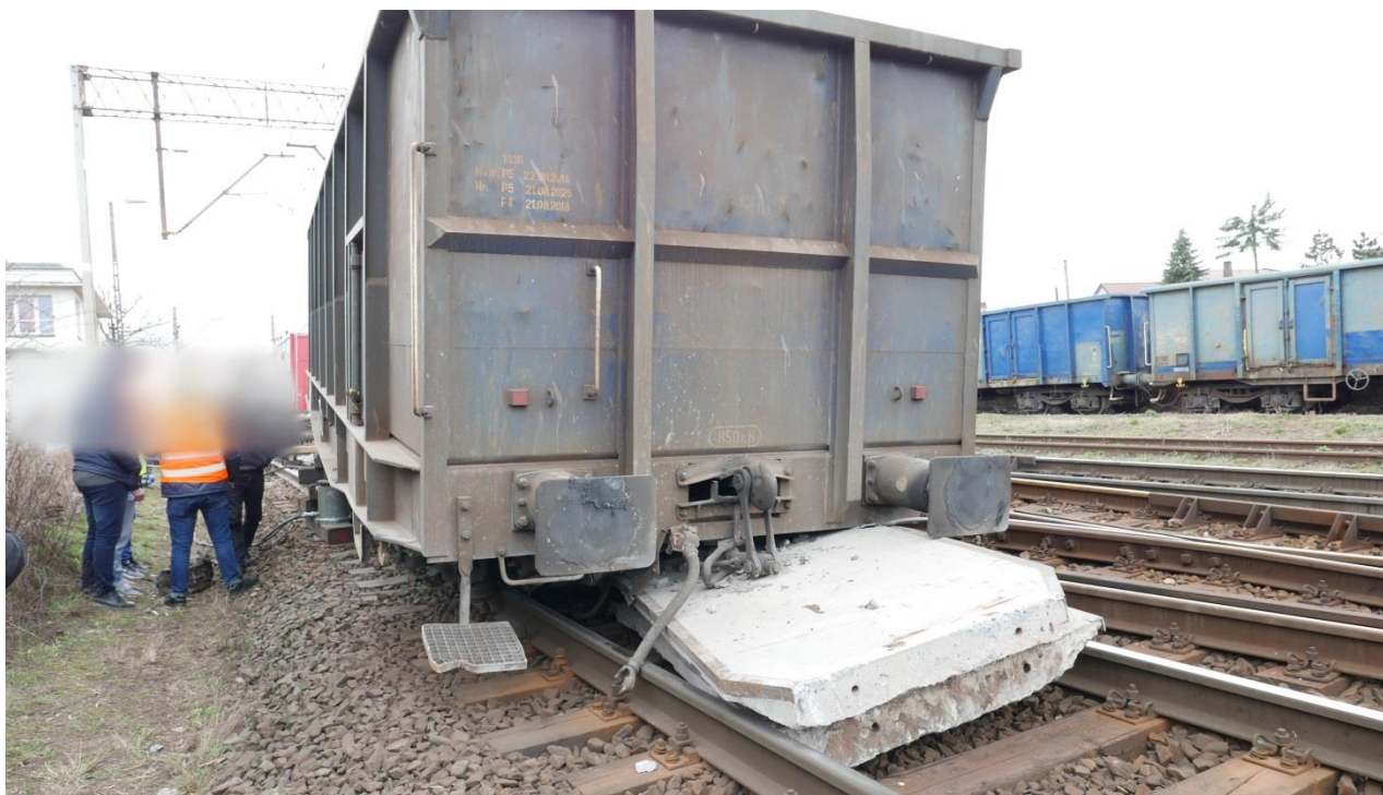
Zdjęcie 1 - Uszkodzony wagon nr 84 51 5945 940-1 po zdarzeniu
