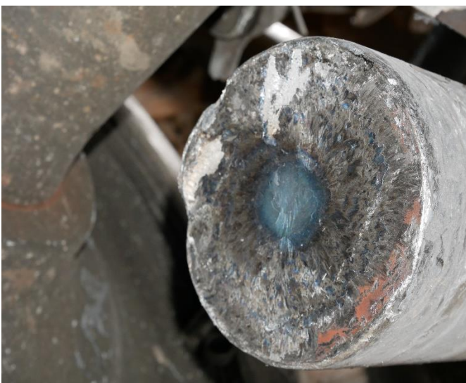
Zdjęcie 5 – złamana druga część osi - wypadek 17.03.2019 r. Pleszew
