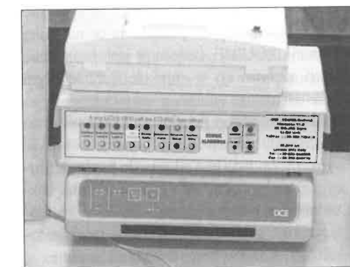
Na zdjęciu u góry stacja ECURIE w centrali w Luksemburgu (z prawej widoczny monitor stacji zapasowej). Szef centrali Vesa Tanner wskazuje na blok aparatury (od góry: modem, ALARMBOX, telex — obecnie wycofany). Na zdjęciu pod spodem powiększenie
