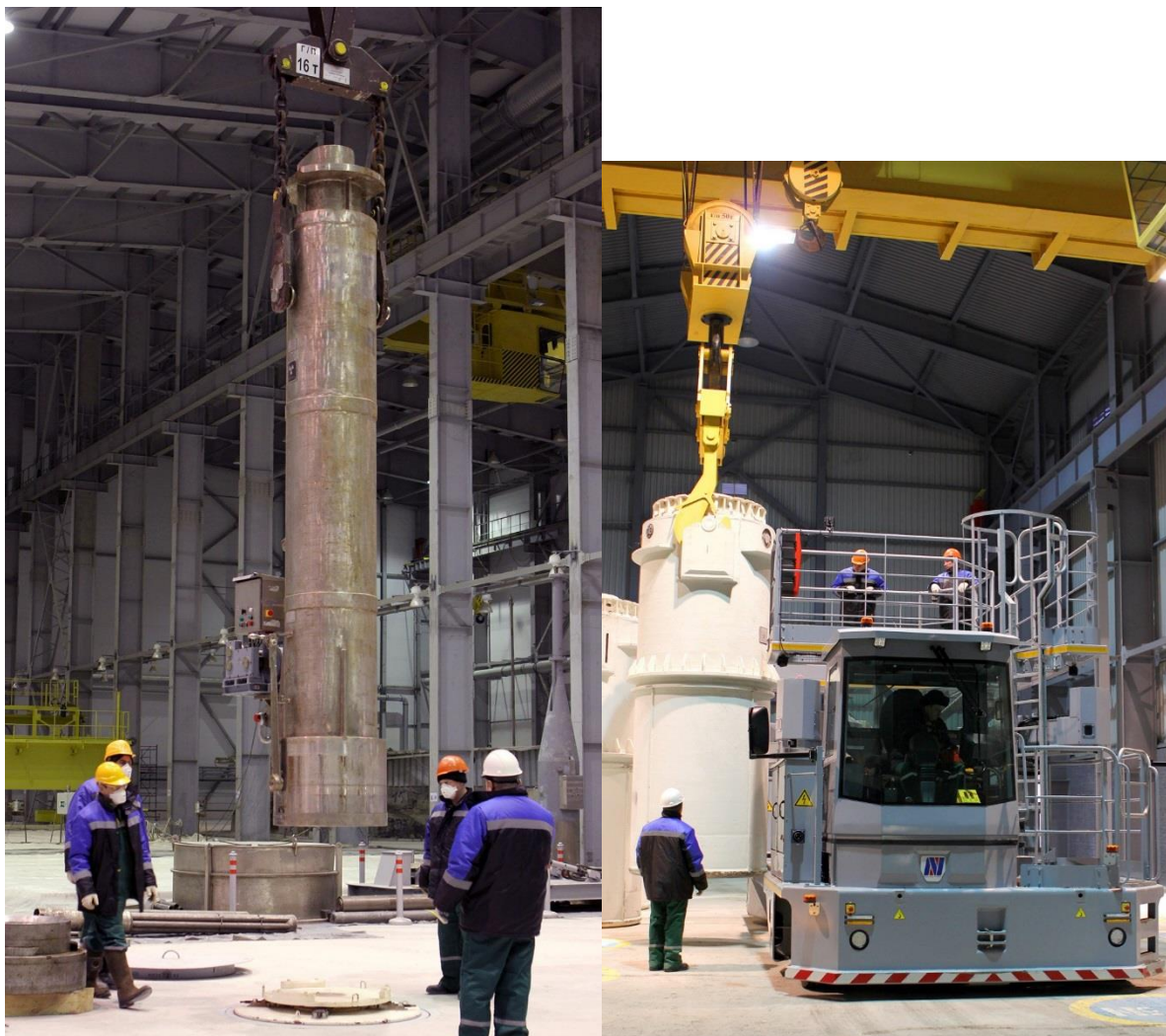
Rys. 5, 6 Prace przy przeładunku wypalonego paliwa
