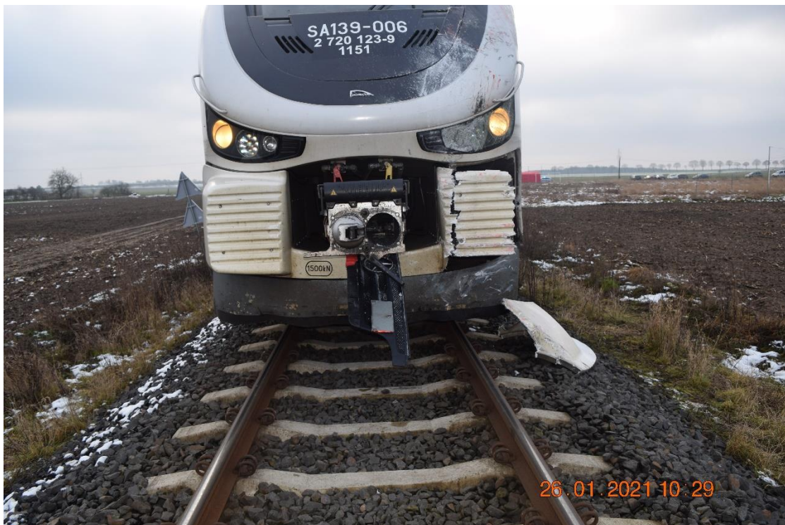
Zdjęcie 5 - Widok uszkodzeń czola pojazdu kolejowego po wypadku
