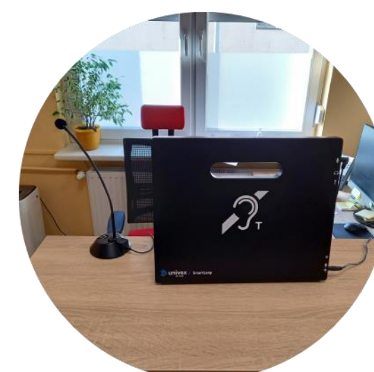
Przenośna pętla indukcyjna - stanowiskowa, dla osób niedosłyszących
