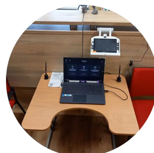
Specjalistyczny zestaw komputerowy sterowany za pomocą ruchu gałek ocznych
