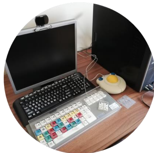
Specjalistyczny zestaw komputerowy sterowany za pomocą ruchu głowy
