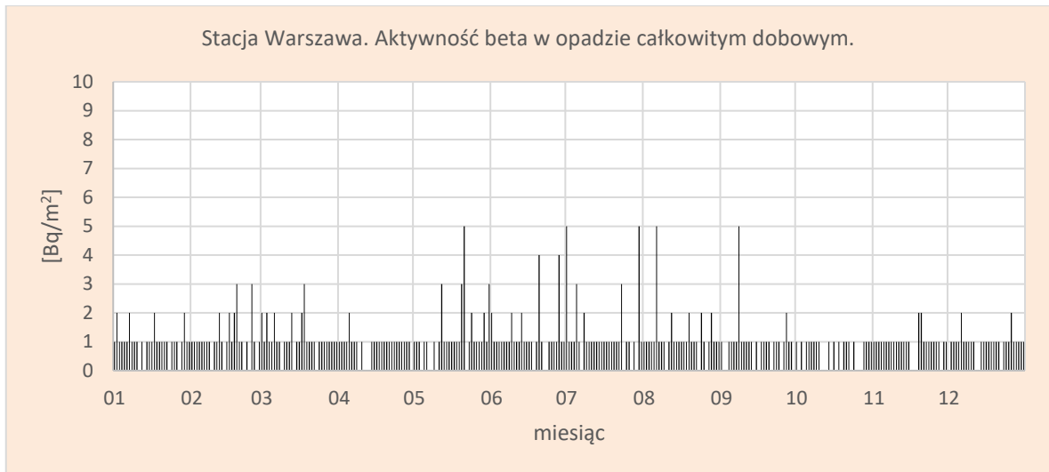
Rys.33. Stężenie promieniotwórcze izotopów beta w całkowitym opadzie dobowym na stacji Warszawa w 2022 roku
