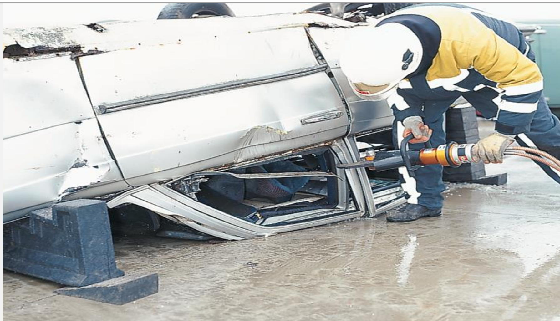
Zdjęcie 2 Stabilizacja pojazdu na dachu
