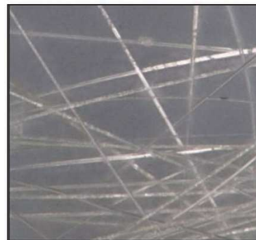
Ilustracja 7. Przykład włókien szklanych w budowlanych materiałach izolacyjnych
