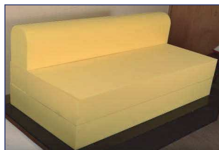
Ilustracja 6. Pianka poliuretanowa zawierająca halogenowane środki zmniejszające palność.
