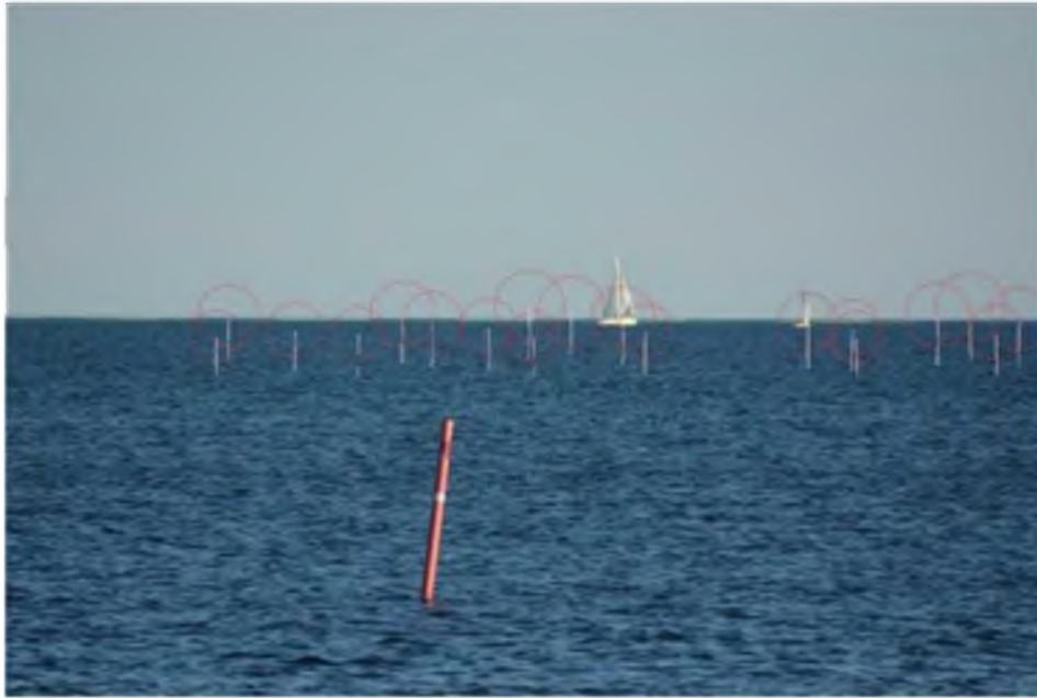
Rys. 47. Analiza wizualna oparta na tym samym zdjęciu, co dolny obraz na Rys. 46. W analizie turbiny oznaczone są czerwonymi kółkami i narysowane przed morzem, chociaż w rzeczywistości zasłania je krzywizna morza. Analiza pokazuje, że najbliższe turbiny w lewej części zdjęcia wystają na wysokość około 200 m z morza (część nad horyzontem), ale ze względu na ograniczoną widoczność bardzo trudno jest dostrzec turbiny na Rys. 46.
