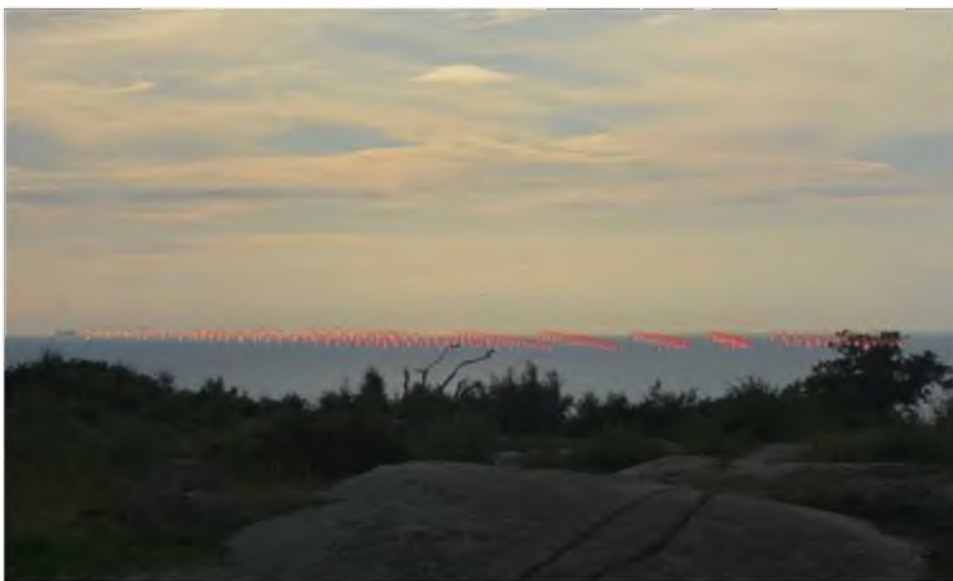
Rys. 45. Analiza wizualna na podstawie tego samego zdjęcia co na Rys. 44. W analizie turbiny oznaczone są czerwonymi kółkami i narysowane przed morzem, chociaż w rzeczywistości zasłania je krzywizna morza. Analiza pokazuje, że najbliższe turbiny w lewej części zdjęcia wystają na wysokość około 200 m z morza (część nad horyzontem), ale ze względu na ograniczoną widoczność bardzo trudno jest dostrzec turbiny na Rys. 44.
