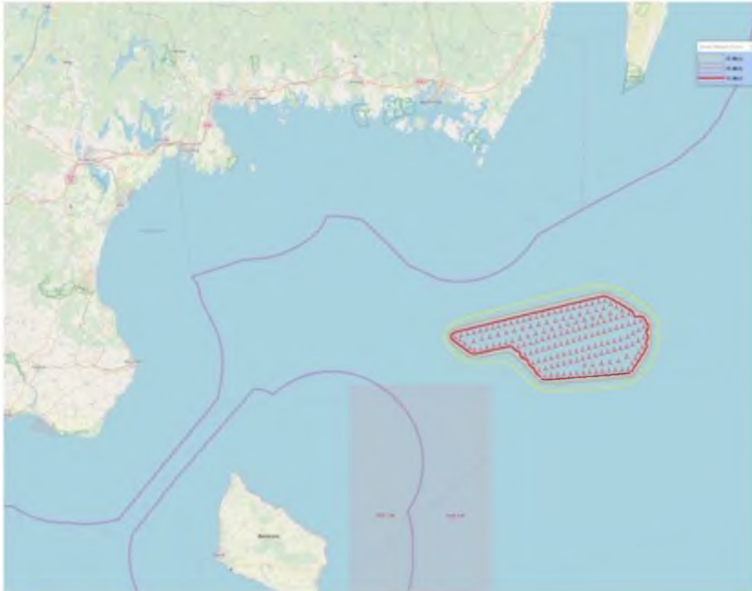
Rys. 48. Obliczona dyspersja dźwięku wokół Baltic Offshore Beta w modelu duńskim, na podstawie przykładowego układu 167 turbin wiatrowych i dźwięku źródłowego 115 dB(a).
