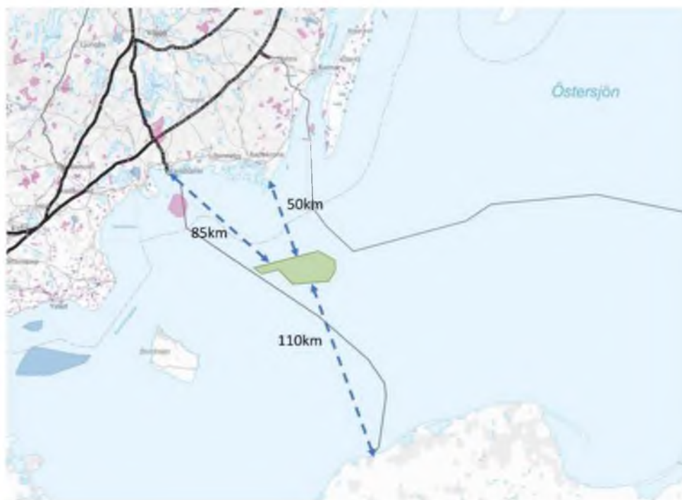
Rys. 2. Lokalizacja i odległość obszaru projektu od lądu. Odległość do Simrishamn wynosi 85-90 km. Istniejące połączenia z państwami bałtyckimi widoczne są po wschodniej stronie obszaru, a istniejące połączenie z Polską po stronie zachodniej.
