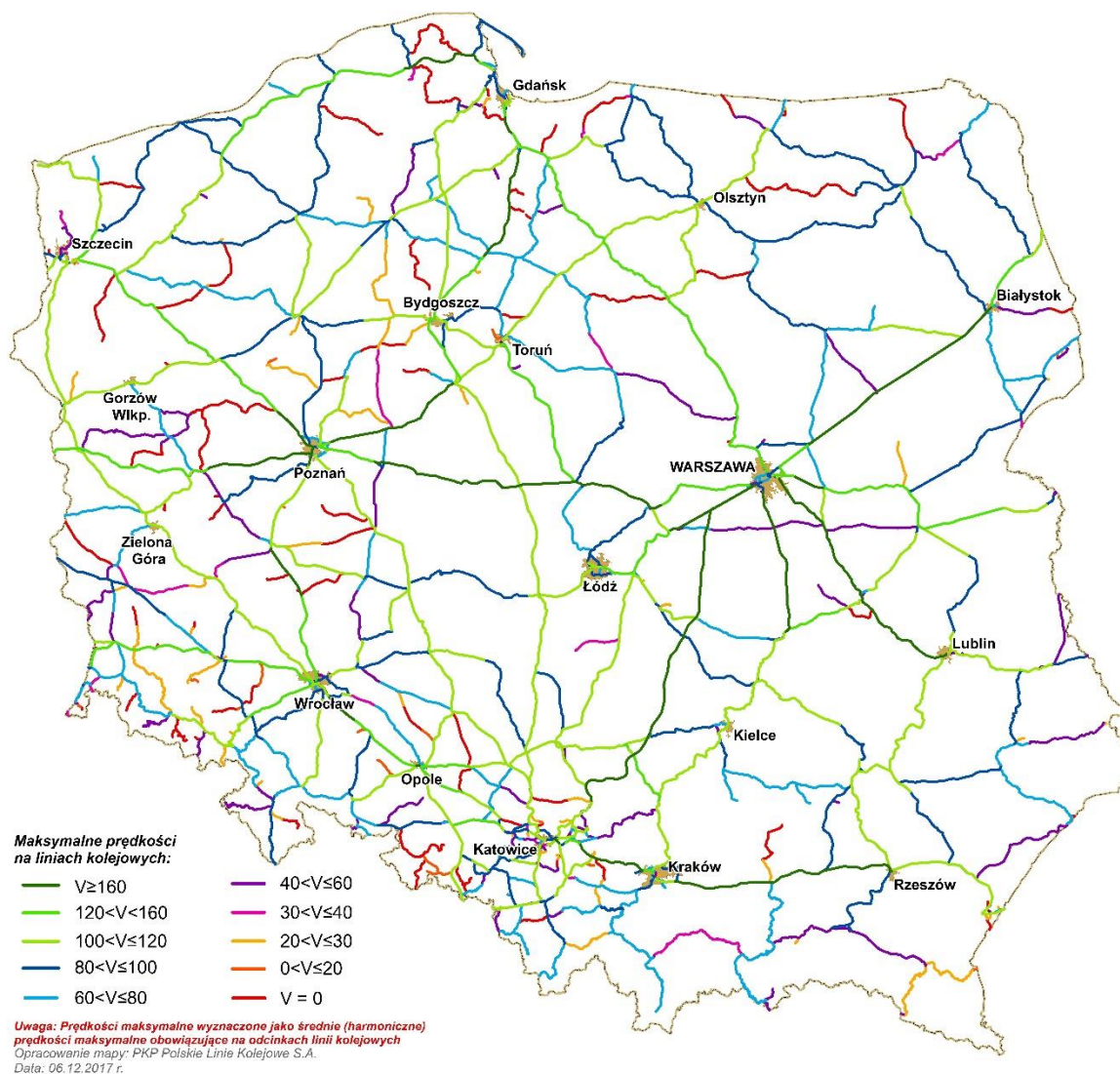
Mapa 4 Prędkości maksymalne na liniach/odcinkach sieci kolejowej zarządzanej przez PKP PLK SA – prognoza na 31.12.2023 r.
