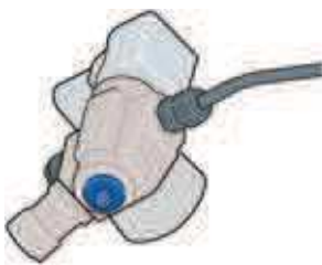
Ręczny zawór odcinający na zaworze głównym zbiornika
