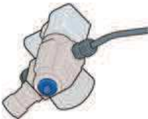
Ręczny zawór odcinający u podstawy zaworu głównego zbiornika
