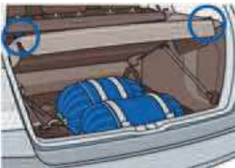
Zbiorniki gazu pod podłogą bagażnika
