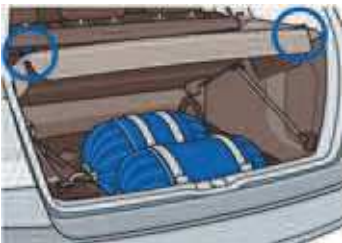
Zbiorniki gazu pod podłogą bagażnika
