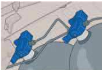
Elektromagnetyczne zawory odcinające na zbiornikach gazu
