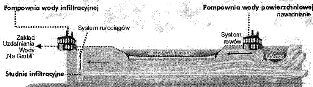
Rysunek 1: Schemat ujmowania wody dla ZPW Nr 2 „Na Grobli” ( źródło: https://mpwik.wroc.pl/o-nas/wodociagi/ )
