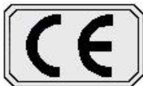
Rysunek nr 6.2. Oznaczenie CE, które musi posiadać agregat prądotwórczy oraz wszystkie inne urządzenia elektryczne
