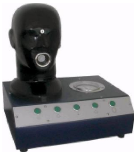
Fotografia nr 9.10. Przyrząd do badania szczelności masek
