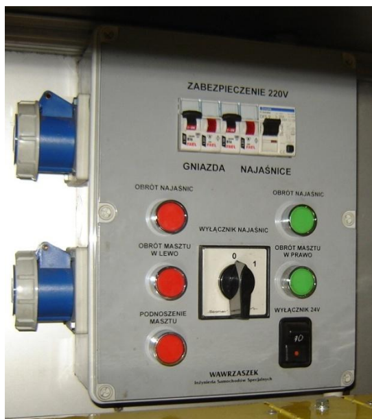
Fotografia nr 6.11. Stanowisko obsługi masztu wbudowanego na stałe w zabudowę samochodu pożarniczego.
