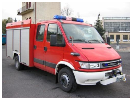
Fotografia nr 5.6. Wciągarka elektryczna zamocowana do ramy podwozia samochodu ratowniczo-gaśniczego
