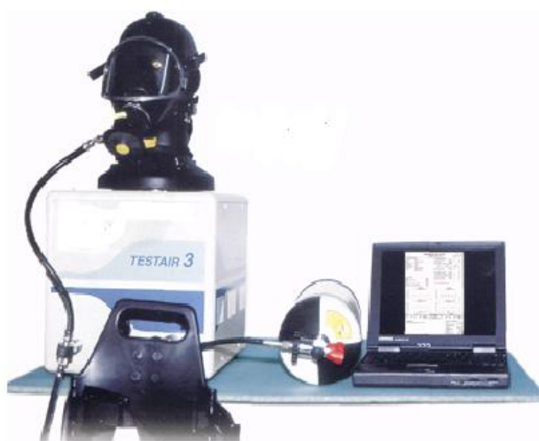
Fotografia nr 9.11. Urządzenie do dynamicznego badania pracy aparatów powietrznych
