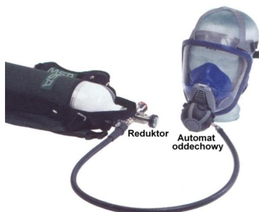
Fotografia nr 9.2. Reduktor dwustopniowy o stopniach rozdzielonych. Wąż łączący reduktor z automatem oddechowym (reduktor drugiego stopnia) pełni rolę komory średniego ciśnienia.
