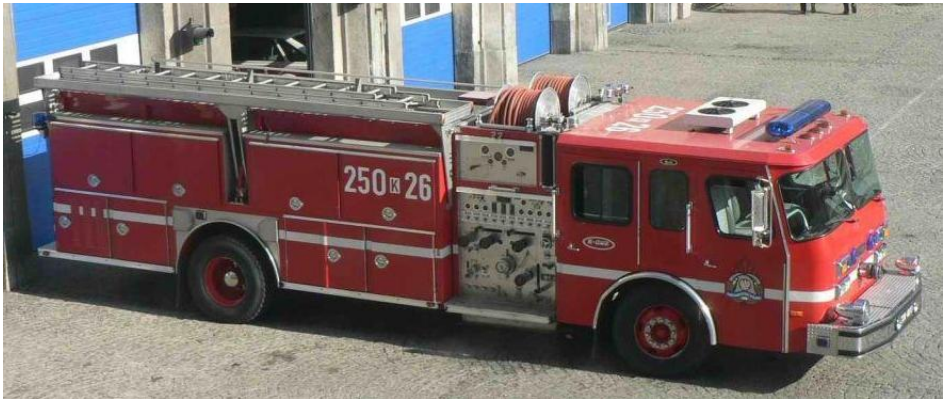
Fotografia nr 4.5. Autopompa umieszczona za silnikiem, stanowisko obsługi na boku pojazdu.
