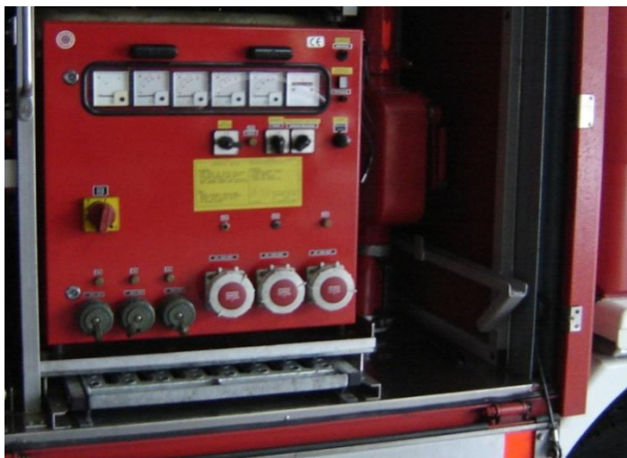
Fotografia nr 6.4. Pulpit obsługowo-kontrolny wraz z przyłączami agregatu na stałe wbudowanego do pojazdu pożarniczego
