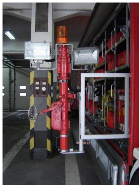
Fotografia nr 6.13. Maszt oświetleniowy wysuwany na panelu z zabudowy samochodu, podnoszony ręcznie przy pomocy korby
