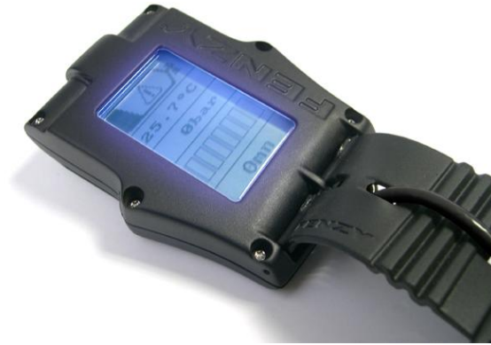
Fotografia nr 9.4. Bezprzewodowy wskaźnik ciśnienia w aparacie noszony na przedramieniu
