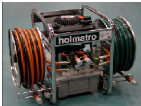
Fotografia nr 7.15. Agregat zasilający z silnikiem spalinowym
