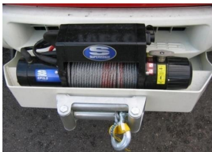
Fotografia nr 5.6. Wciągarka elektryczna zamocowana do ramy podwozia samochodu ratowniczo-gaśniczego
