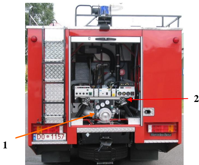
Fotografia nr 5.3. Przedział autopompy samochodu ratowniczo-gaśniczego: 1 – zawór główny układu wodno-pianowego, 2 – zawór otwarcia linii tłocznej
