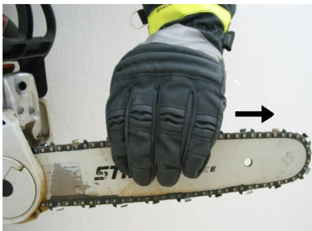
Fotografia nr 8.2. Sprawdzenie płynności ruchu łańcucha
