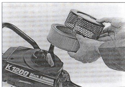
Fotografia nr 8.7. Wyjęcie filtra z obudowy
