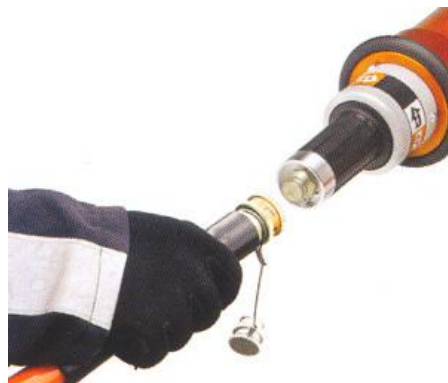
Fotografia nr 7.14. Sposób łączenia przewodu z narzędziem w systemie jednowężowym
