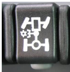
Fotografia nr 5.4. Oznakowanie włącznika przystawki dodatkowego odbioru mocy
