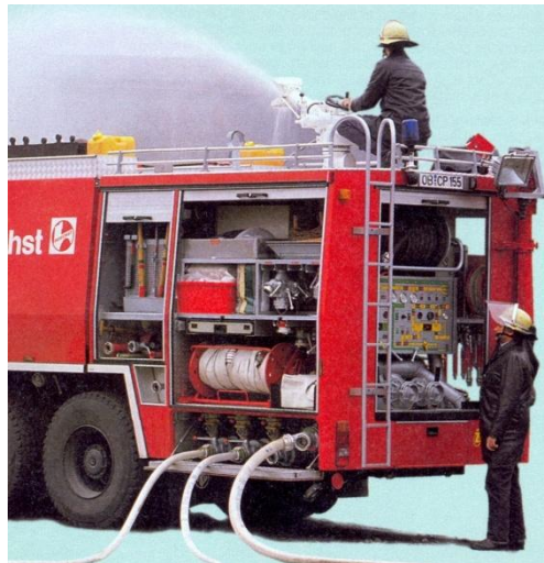
Fotografia nr 4.6. Autopompa umieszczona z tyłu samochodu
