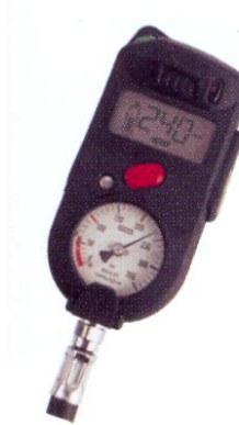
Fotografia nr 9.5. Widok zintegrowanego czujnika kontrolnego
