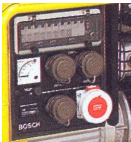
Fotografia nr 6.6. Panel obsługowo kontrolny
