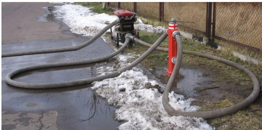
Fotografia nr 4.8. Zasilanie strony ssawnej motopompy bezpośrednio z hydrantu przez zbieracz
