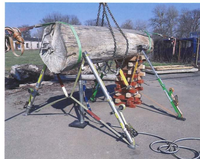
Nadanie więzów stopniom swobody w różnych konfiguracjach sprzętowych – pewność stabilizacji fot. Rafał Podlasiński
