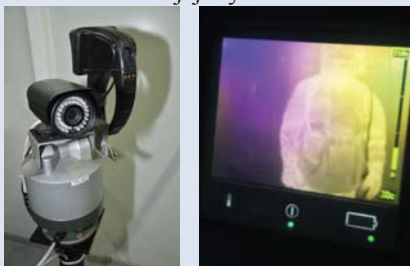
kamera termowizyjna oraz podgląd obrazu na jej wyświetlaczu
