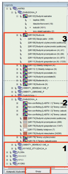
Ryc. 3. Struktura wizualizacji kartograficznej: [1] grupy warstw, [2] warstwy tematyczne o zdefiniowanej symbolizacji, [3] nakładki tematyczne (klasyfikacje, kartogramy itp.)
