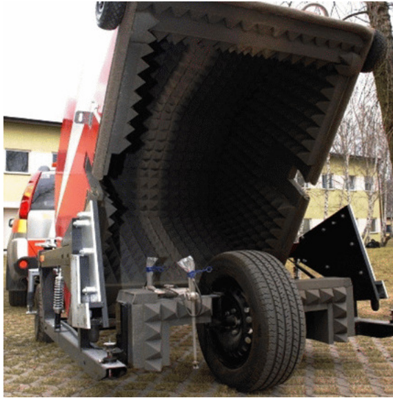
Rysunek 3. Widok wnętrza komory przyczepy Tiresonic Mk.4
