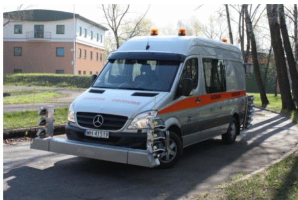
Rysunek 17. Profilograf laserowy SPDE (IBDiM)
