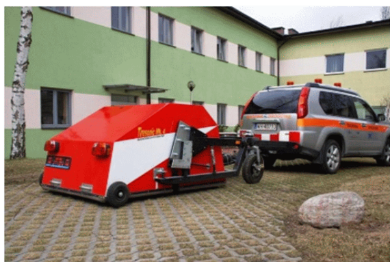
Rysunek 2. Zestaw pomiarowy do pomiaru hałaśliwości nawierzchni metodą CPX
