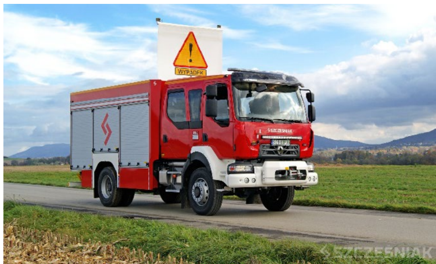
■ Prototyp średniego samochodu ratowniczo-gaśniczego na podwoziu Renault D16 4x4
