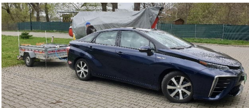
■ Testowe podłączenie zasobnika wodoru do samochodu osobowego (Toyota Mirai)
