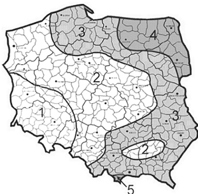
Rysunek NB.1– Podział Polski na strefy obciążenia śniegiem gruntu
