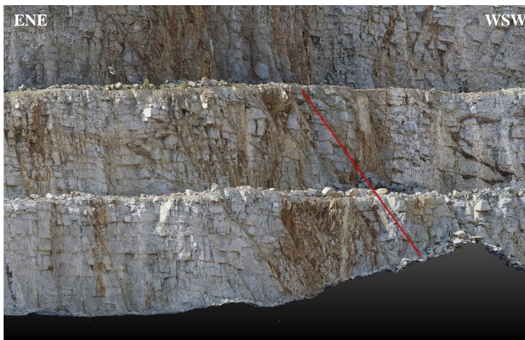
Figura 5.55. Kłm w Górcie Sobockiej, widok na powierzchnie o orientacji 290/60 (jedna podkreślona na czerwono). Obraz wyrenderowano na podstawie modelu 3d kierunku patrzenie zgodny z biegiem spękań 290/60 (widok skośny do ściany).
