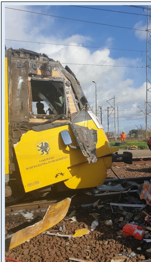
Zdjęcie 30– Skutki zdarzenia uszkodzenie SA138-004 (źródło: materiał własny PKBWK)
