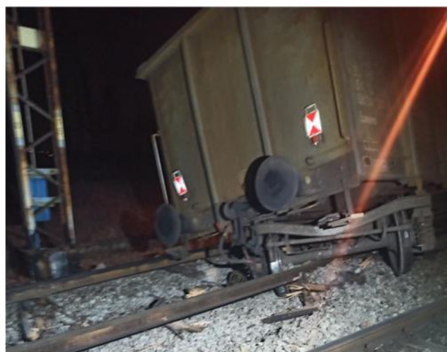
Zdjęcie 13 - Widok wykolejonego wagonu (źródło: materiały przekazane przez komisję kolejową)
