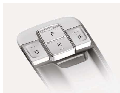
Włączyć tryb P przekładni redukcyjnej (przycisk P).
