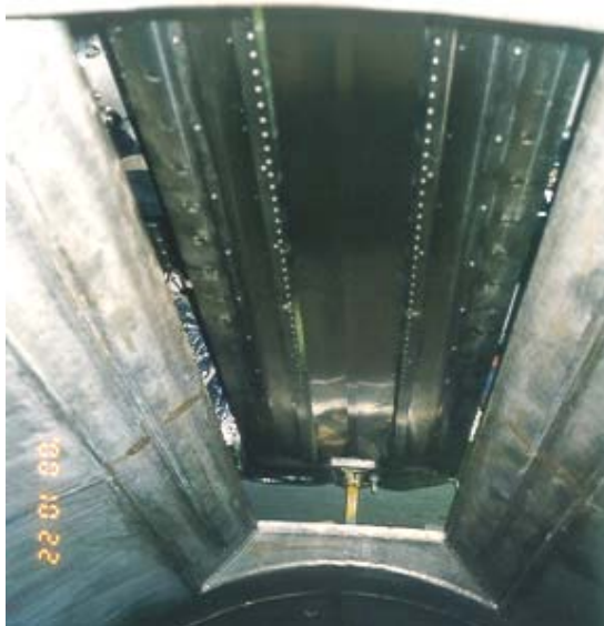
Rys. 9.14. Widok okna wyjściowego akceleratora z folii tytanowej
