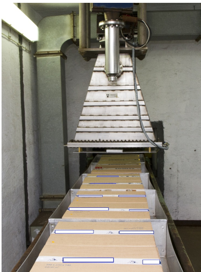
Rys. 9.2. Proces sterylizacji radiacyjnej wyrobów medycznych w opakowaniach zbiorczych
