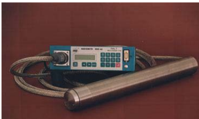
Rys. 4.3. Zestaw do długookresowych pomiarów zmian stężenia radonu z sondą SRDN2
