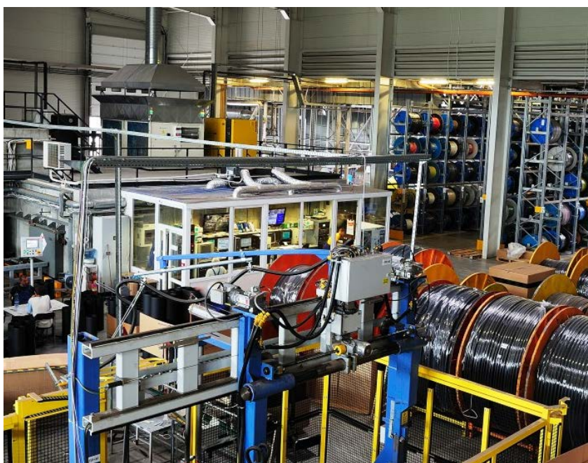
Rys. 9.5. Widok hali technologicznej i sterowni akceleratora typu IŁU-10 w firmie RADPOL S.A. z Człuchowa produkującej w skali masowej rury i mufy termokurczliwe modyfikowane radiacyjnie
