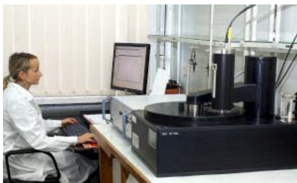
Rys. 7.5. Pomiar na czytniku termoluminescencji przystosowanym do wykrywania napromieniowanej żywności, z której wyizolowano minerały krzemianowe (PN-EN 1788)
