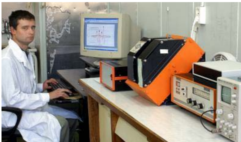
Rys. 7.6. Pomiar na spektrometrze elektronowego rezonansu paramagnetycznego (ERP) przystosowanym do badań żywności zawierającej po napromieniowaniu trwałe rodniki (PN-EN 1786, PN-EN 1787, PN-EN 13708)
