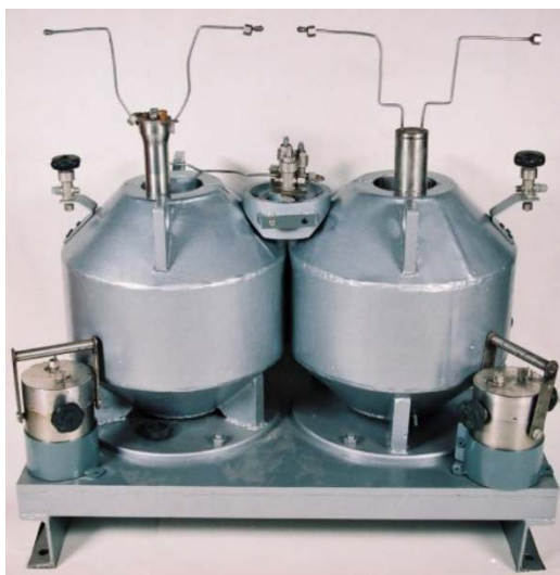
Rys. 4.18. Przemysłowy generator wytwarzania bromku metylu CH 3 Br znakowanego radioizotopem Br-82
