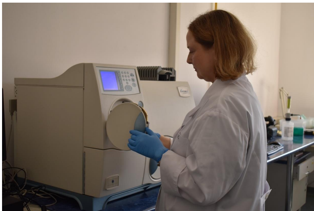
Fot: Justyna Mańkowska Identyfikacja biochemiczna przy użyciu kart GN do analizatora mikrobiologicznego Vitek 2 Compact 15
