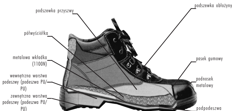
Elementy składowe trzewika ochronnego.
