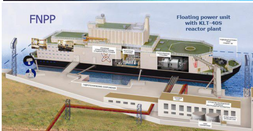
Rys. 4. Pływająca elektrownia KLT-40S zacumowana przy nadbrzeżu
