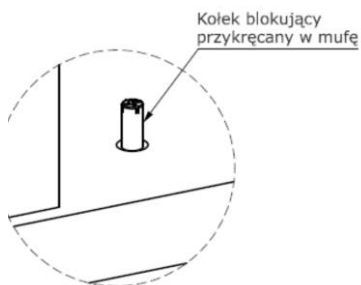
rys. 5 – kołek blokujący zamek
