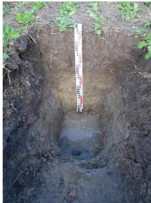
Rys. 2 Odkrywka do poziomu wody gruntowej
