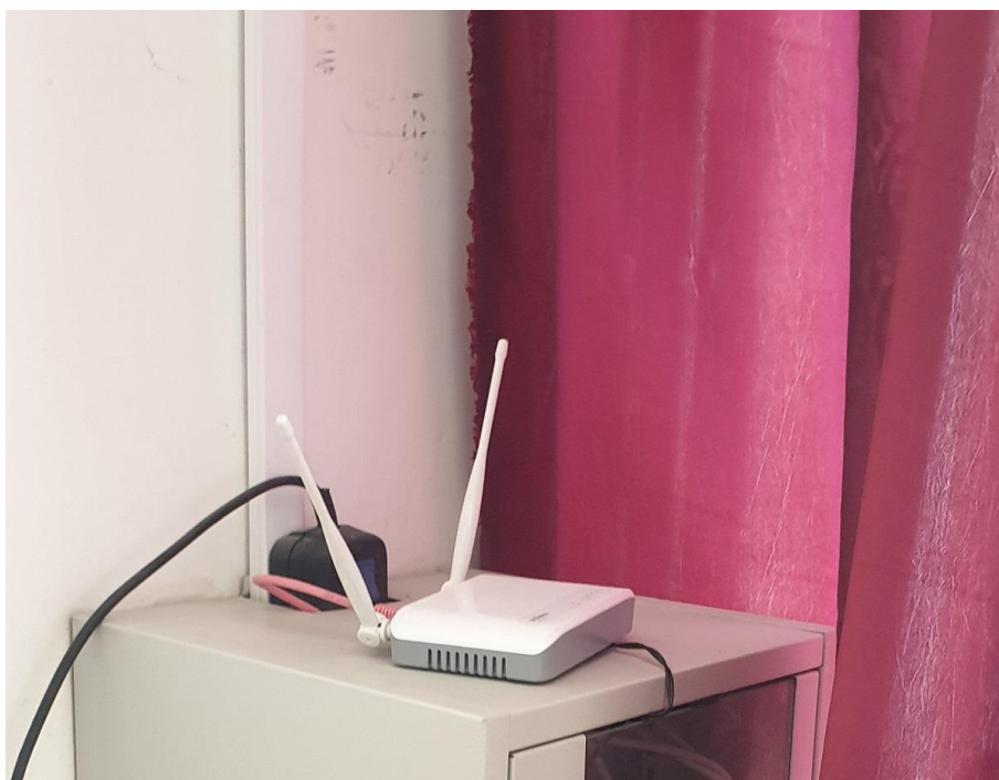
Fot. 4: Zdjęcie punktu dostępowego model BR-6428nS V2
