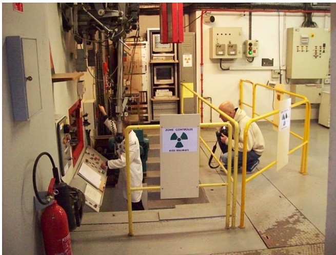
Wnętrze komory do napromieniowania można oglądać przez wizjer wykonany ze specjalnego gatunku szkła.
