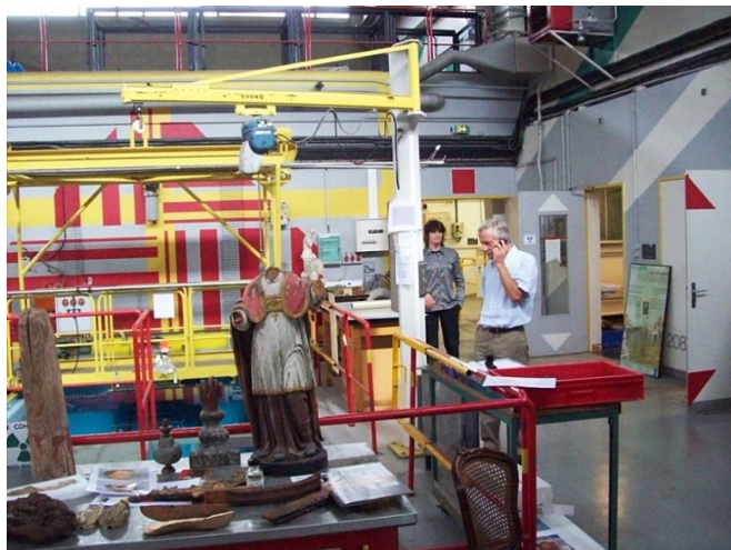
Widok instalacji radiacyjnej promieniowania gamma. Na stole ekspozycyjnym poddane konsolidacji radiacyjnej.
