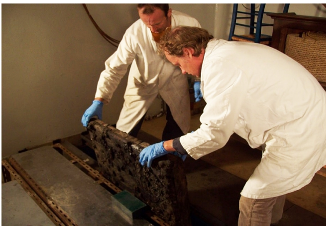
Obiekt drewniany po nasączeniu roztworem polimeru w monomerze umieszczany w komorze do napromieniowania.
