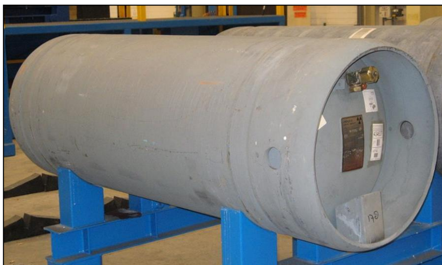
Rys. 4. Cylinder typu 30B przeznaczony do transportu i przechowywania UF 6
