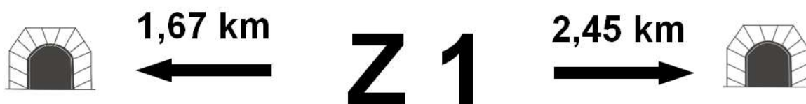
Rys. Z.3. Znak na ścianie zatoki wskazujący odległość do wlotów tunelu w km
