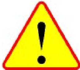
Rys. Z.8. Znak A-30. Ostrzega o niebezpieczeństwie innego rodzaju niż określone pozostałymi znakami ostrzegawczymi
