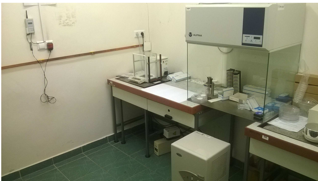
Rysunek 3.1. Wyposażenie pokoju wagowego w IPIŚ PAN (mikrowaga z bramką dejonizacyjną, komora laminarna do kondycjonowania filtrów, humidyfikator, układ rejestracji temperatury i wilgotności powietrza).
