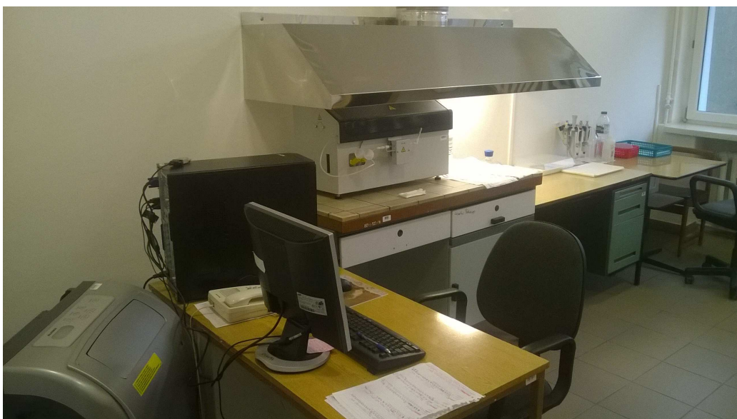
Rysunek 3.2. Wyposażenie pokoju analiz Hg w IPIŚ PAN (analizator rtęci MA-2 z osprzętem, fragment systemu wyciągowo-nawiewnego z klimatyzatorem).
