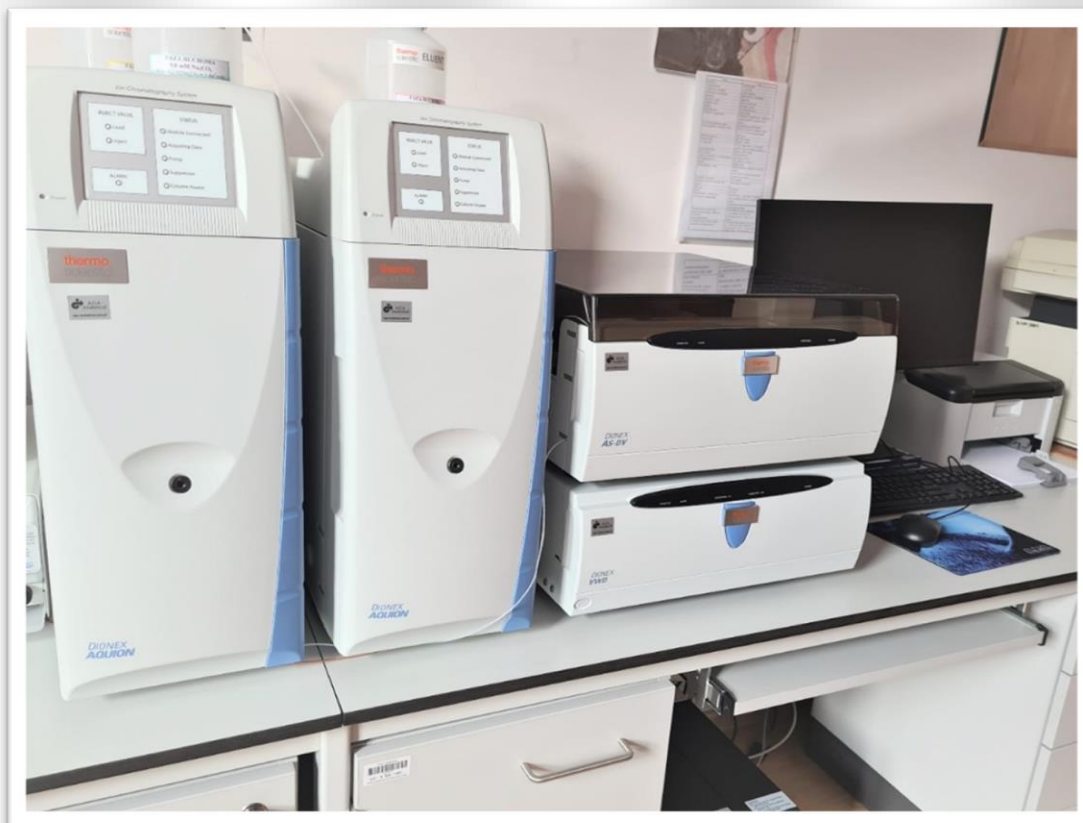
Badania chemiczne wody przy użyciu chromatografu jonowego. Zdjęcie WSSE Białystok - zasoby własne.
