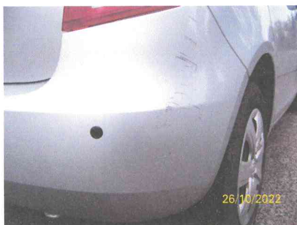
Zarysowany narożnik zderzaka i uszkodzony lakier na obrzeżu drzwi TL
