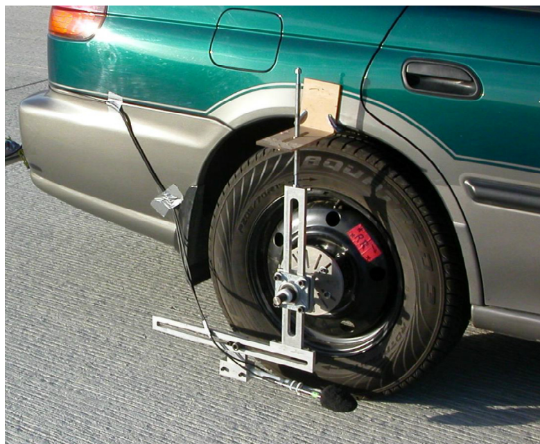
Rysunek 7. Urządzenie OBSI o pojedynczym mierniku zainstalowane w piaście prawego tylnego koła pojazdu testowego
