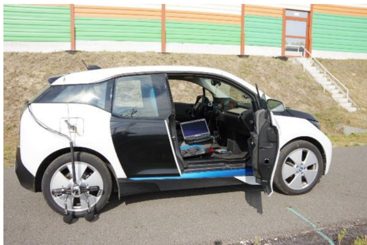
Rysunek 9. Zestaw pomiarowy OBSIe zamontowany na pojeździe EV, BMW i3
