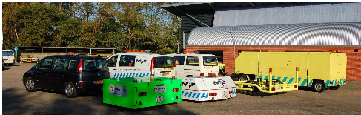
Rysunek 12. Zestawy pomiarowe do pomiarów CPX stosowane w badaniach na „Round Robin”
