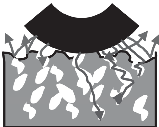
Rysunek 18. Możliwe mechanizmy ograniczania hałasu na nawierzchniach porowatych
