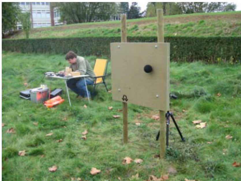
Rysunek 1. Mikrofon SPB zainstalowany na sztywnej odbijającej dźwięk płycie
