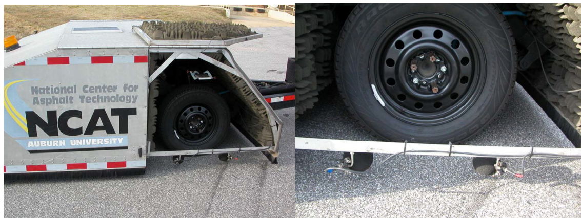
Rysunek 2. Pryczepka CPX wraz z pozycją mikrofonów używana przez NCAT
