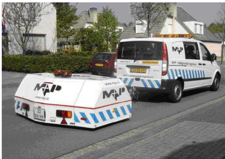
Rysunek 5. Przyczepka M + P do badań metodą CPX
