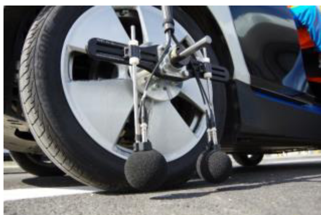
Rysunek 8. System OBSI zamontowany w piaście koła z dwoma miernikami natężenia i osłonami przeciwwietrznymi
