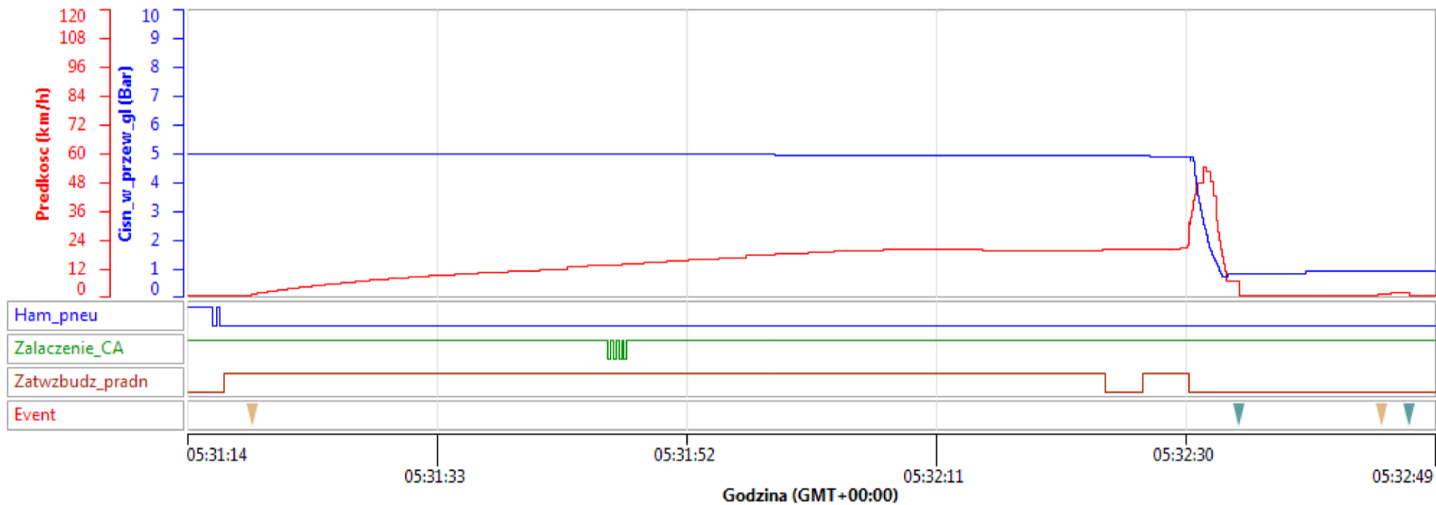
Rysunek 3 - Wykres parametrów jazdy lokomotywy 6Dg-140 s w funkcji czasu (opr. PKBWK)
