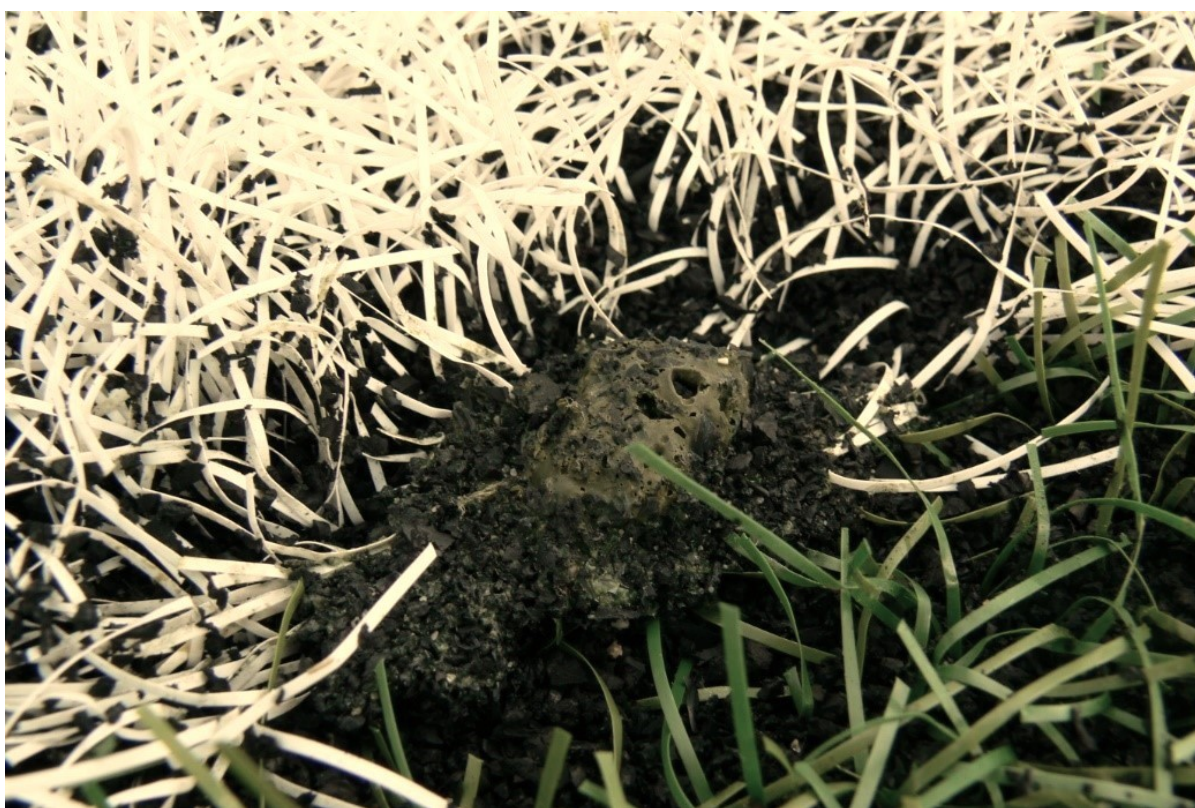
Fot. 5 Spienienie się kleju w miejscu połączenia elementów wykładziny.
