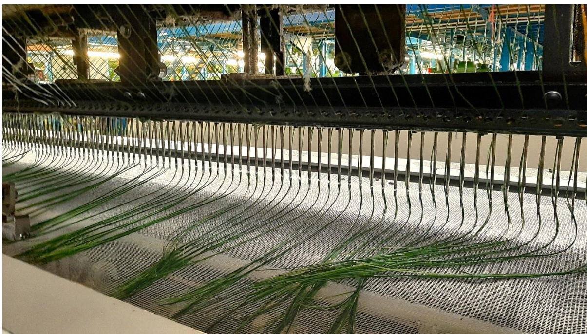
Fot. 1 Proces produkcji trawy metodą tuftowania
