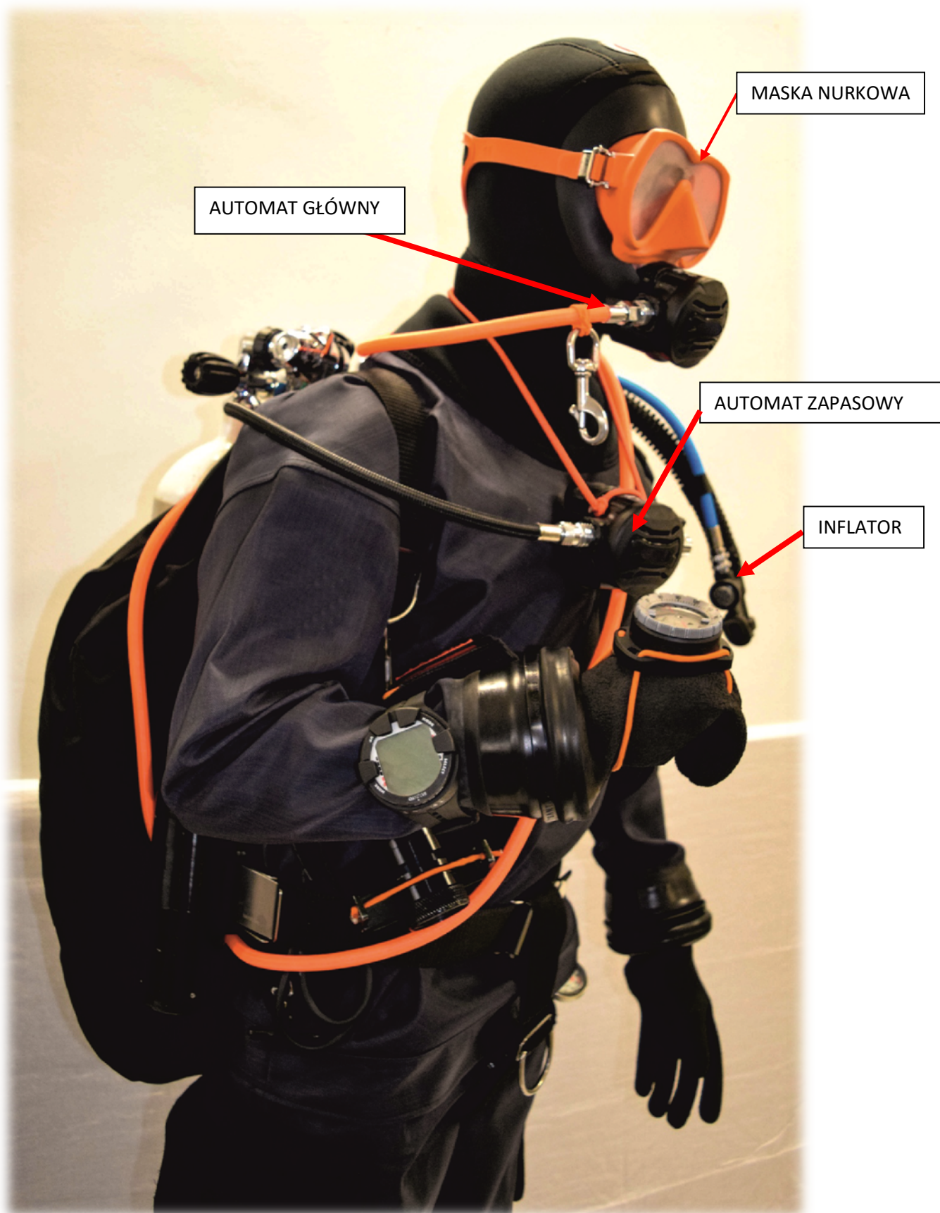
Zdj. 3 Konfiguracja sprzętu nurka z długim węzłem – widok z przodu.
