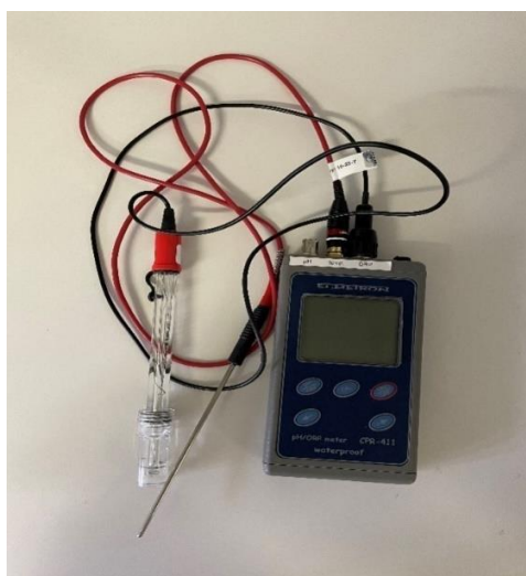
Miernik do wykonywania pomiarów potencjału redox w próbkach wody na pływalniach
