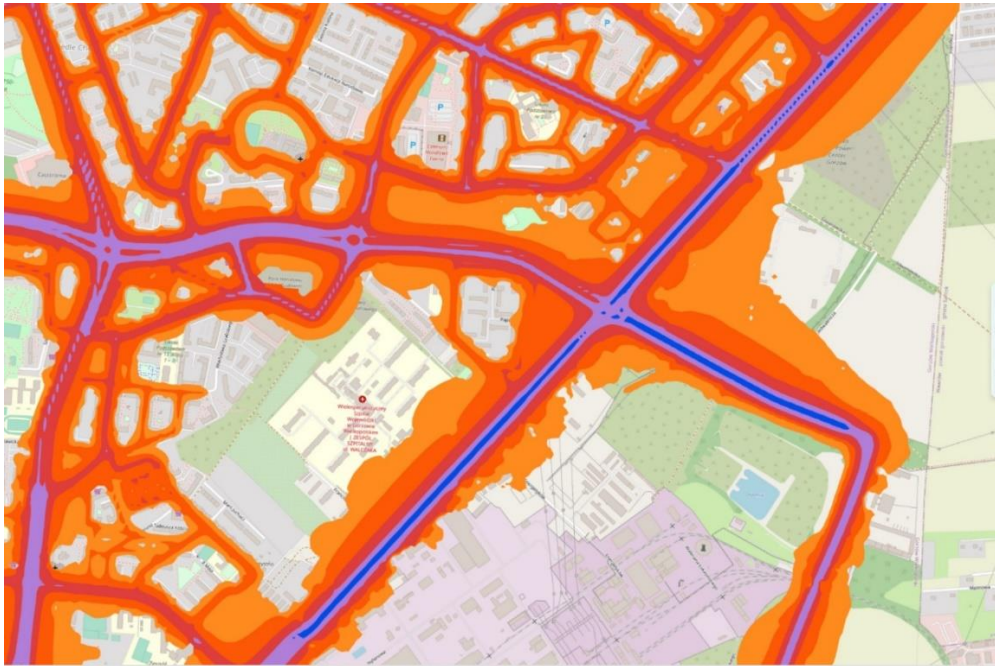
Rysunek 4.1.2. Fragment mapy imisji dla wskaźnika L_{DWN} od dróg miasta Gorzowa Wlkp. (źródło: Baza Ehałas_M/ GIOŚ)
