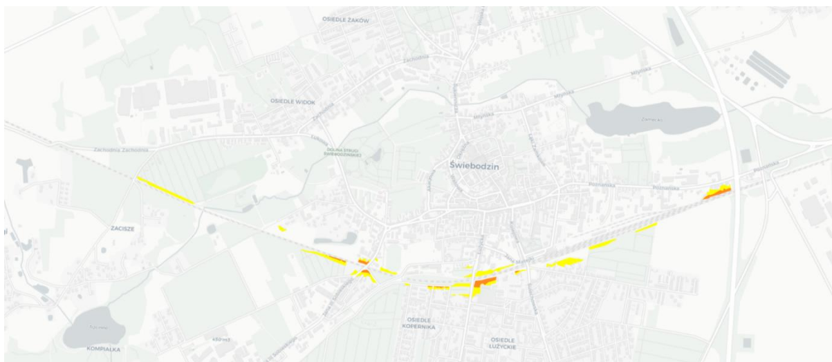
Rysunek. 4.6.2. Fragment mapy terenów zagrożonych dla wskaźnika L_{DWN} od kolei w Świebodzinie (źródło: Baza Ehałas_M/ GIOŚ)
