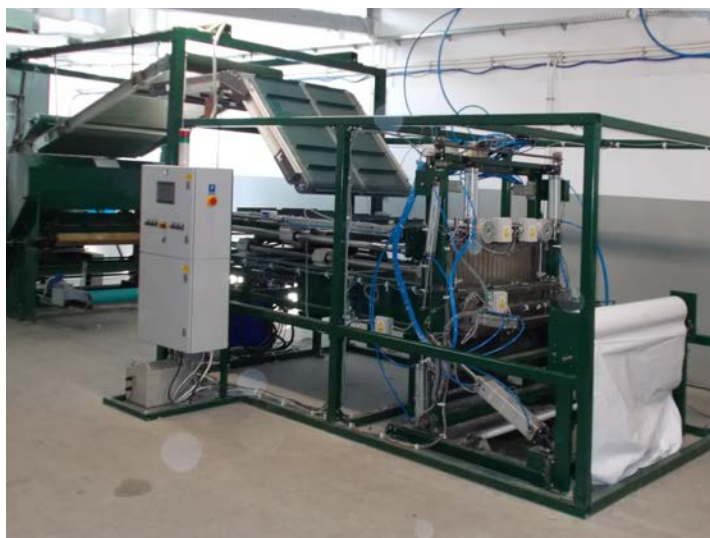
Linia do produkcji włókniny biodegradowalnej, fot. Stanisław Kaniszewski
