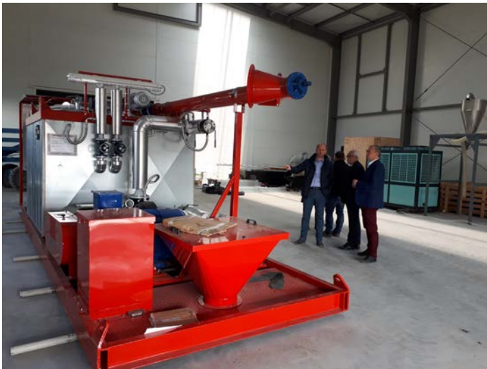
Budowa pilotażowej instalacji emulsji asfaltowych, modyfikowanych nanostrukturami z polimerów odpadowych, Kędzierzyn Koźle, fot. Dariusz Żłobiński
