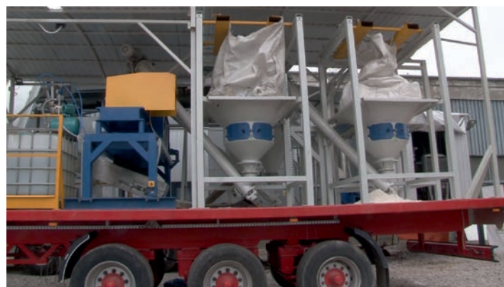
Linia demonstracyjna wytwarzania kruszyw lekkich z osadów ściekowych i krzemionki odpadowej, fot. Marta Karnowska
