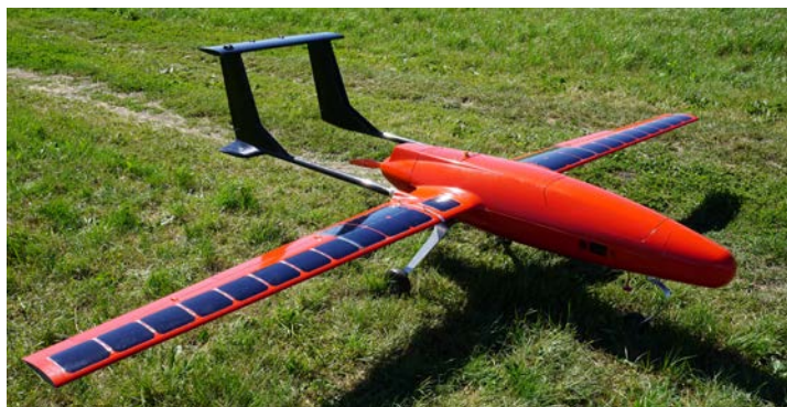
Bezzałogowy Statek Powietrzny Phoenix 1:10, wykorzystywany jako platforma nośna sensorów multispektralnych w projekcie Life+ HESOFF, fot. Instytut Lotnictwa
