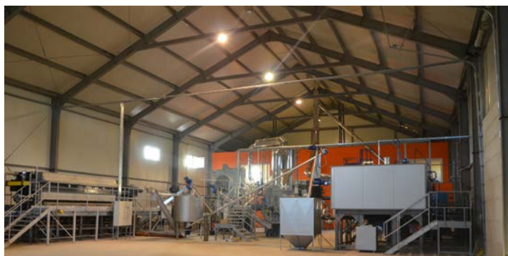
Instalacja termicznej utylizacji osadów pościekowych metodą pirolizy, fot. FU-Wi Sp. z o.o.
