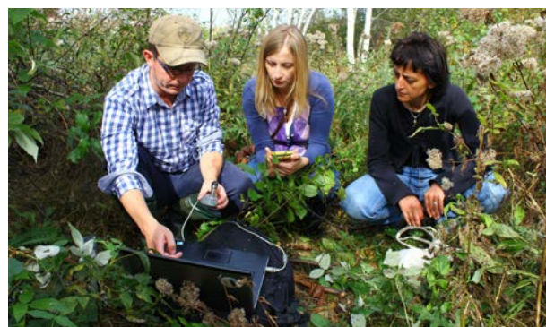
Odczyt danych z urządzeń pomiaru poziomu wód gruntowych, fot. Artur Wiatr
