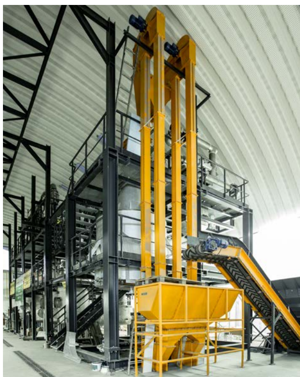
Instalacja demonstracyjna LIFEcogeneration.pl: węzeł zgazowania paliwa formowanego i węzeł oczyszczania syngazu, fot. Investeko S.A.
