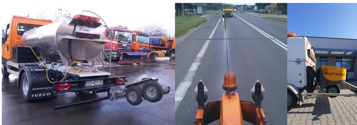
Fotografia 3. a) zestaw pomiarowy TWO – widok z tyłu; b) Pomiar współczynnika tarcia nawierzchni wykonywany w prawym śladzie kół; c) Zestaw ViaFriction – pomiar ciągły
