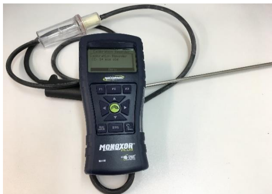
Analizator do pomiaru tlenu węgla MONOXOR Plus
