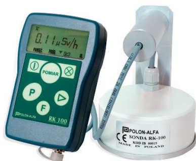
Radiometr RK-100 z sondą zewnętrzną do pomiaru skażeń promieniotwórczych \alpha , \beta , \gamma
