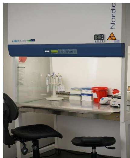
Biobezpieczna komora laminarna z filtrami ULPA
