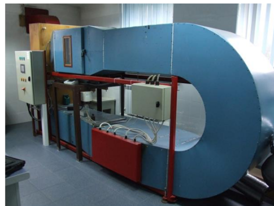
Zdj. 5. Suszarka konwekcyjno-mikrofalowo-ultradźwiękowa (po lewej) oraz klasyczna suszarka konwekcyjna (po prawej).
