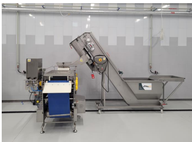
Zdj. 2. Myjka z młynkiem TYP MT-100 – połączona bezpośrednio z prasą do tłoczenia soków PT-1000 (Stalmont)
