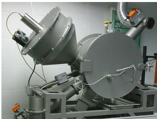
Zdj. 5. Suszarka konwekcyjno-mikrofalowo-ultradźwiękowa (po lewej) oraz klasyczna suszarka konwekcyjna (po prawej).
