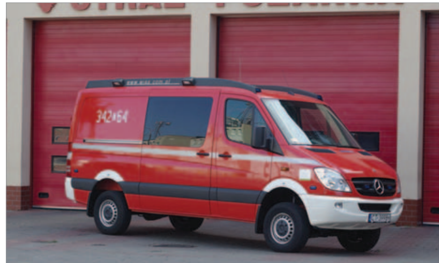
Lekki samochód rozpoznania chemicznego z modulem rozpoznania radiacyjnego SLRch Mercedes-Benz Sprinter 319 CDI
